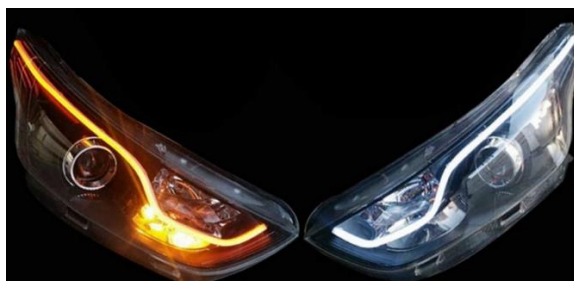
Фиг. 4. Дневни светлини, изработени с главните фарове и мигащи със светлинните пътепоказатели
