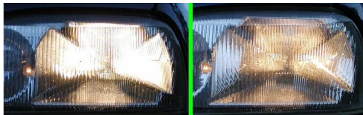
Фиг. 3. Разлика при пълното и редуцираното напрежение към халогенните лампи
